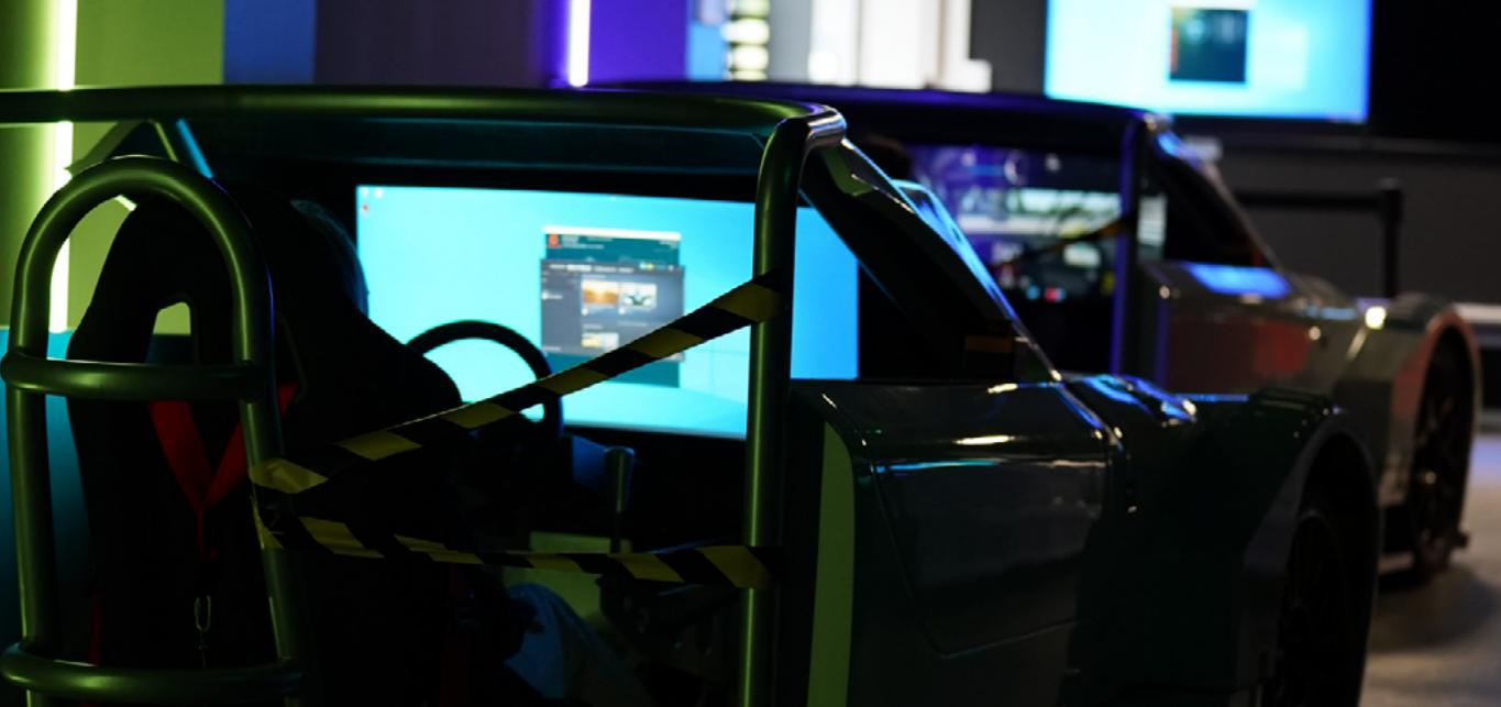
Les simulateurs sont tous constitués d'une plateforme montée sur 6 cervomoteurs qui peuvent restituer des mouvements sur 6 axes de liberté offrant ainsi un ressenti extrêmement réaliste, notamment les sensations d'accélération, de freinage et de limite d'adhérence.
